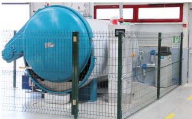
Anlage, die bewirkt, dass die Baumwollfäden stärker werden. Dadurch erhalten die Mops eine längere Lebensdauer.
